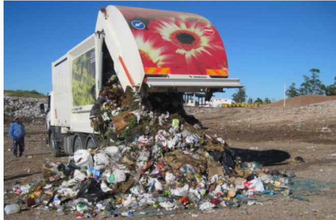
Ilustración 7-2. Descarga del camión sobre la lona.
